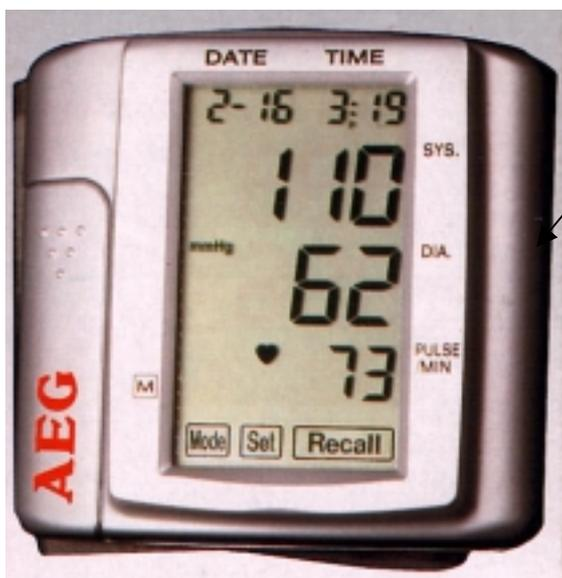
Slika 1: Izgled tlakomjera model AEG A50 s prikazom mjesta za smještaj ovjerne naljepnice
